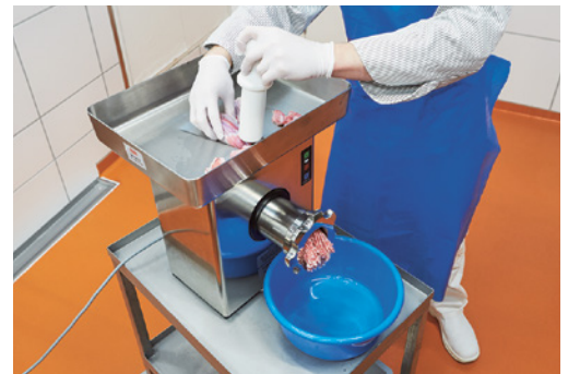
Bild 3: Fleischzufuhr mit Hilfe eines Stopfers
