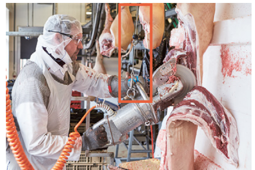
Bild 2: Gewichtsentlastende Aufhängung der Säge
