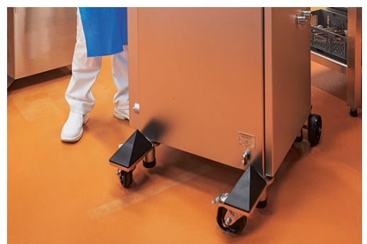
Image 4: machine assurée contre tout déplacement involontaire
