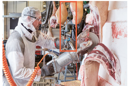
Image 2: système de suspension pour alléger le poids de la scie
