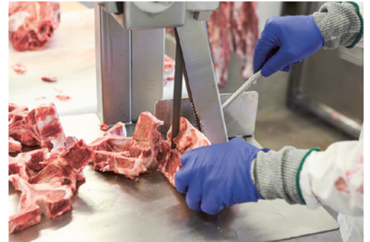
Figura 1: uso corretto del dispositivo di pressione
