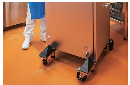
Figura 4: bloccaggio della macchina per evitare spostamenti accidentali
