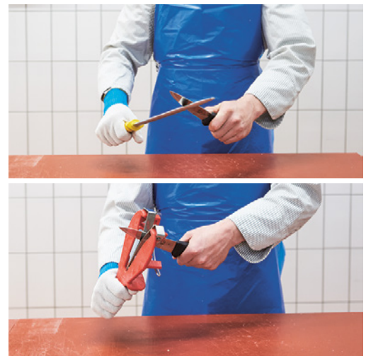
Bild 2: Fachgerechtes Schleifen der Messer
